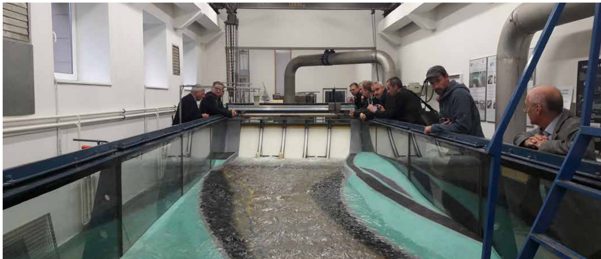
Model přehradní hráze vodního díla Nové Heřminovy 1 : 35 (s úpravou koncepce)
