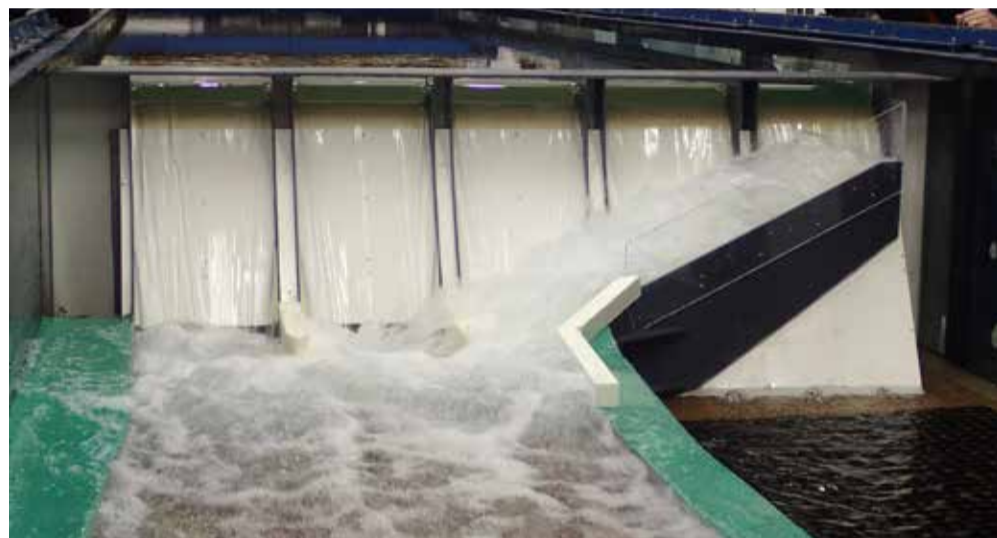
Model přehradní hráze vodního díla Nové Heřminovy 1 : 35 (výchozí návrh)
